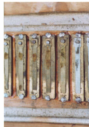
Harmonium in Tafelform, Hermann Alert, Berlin um 1860 Detailansicht mit Zungen
